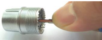
Presione la muesca con el dedo después de conectar
