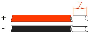
Figura 3-16 Diagrama de pelado de la entrada de CC (unidad: mm)
