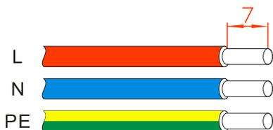
Figura 3-21 Diagrama de pelado de salida de CA (unidad: mm)
